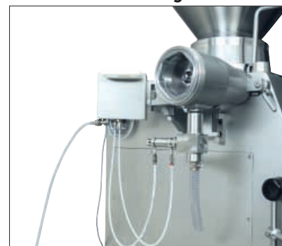
Dispositif pneumatique de séparation des nerfs et cartilages
